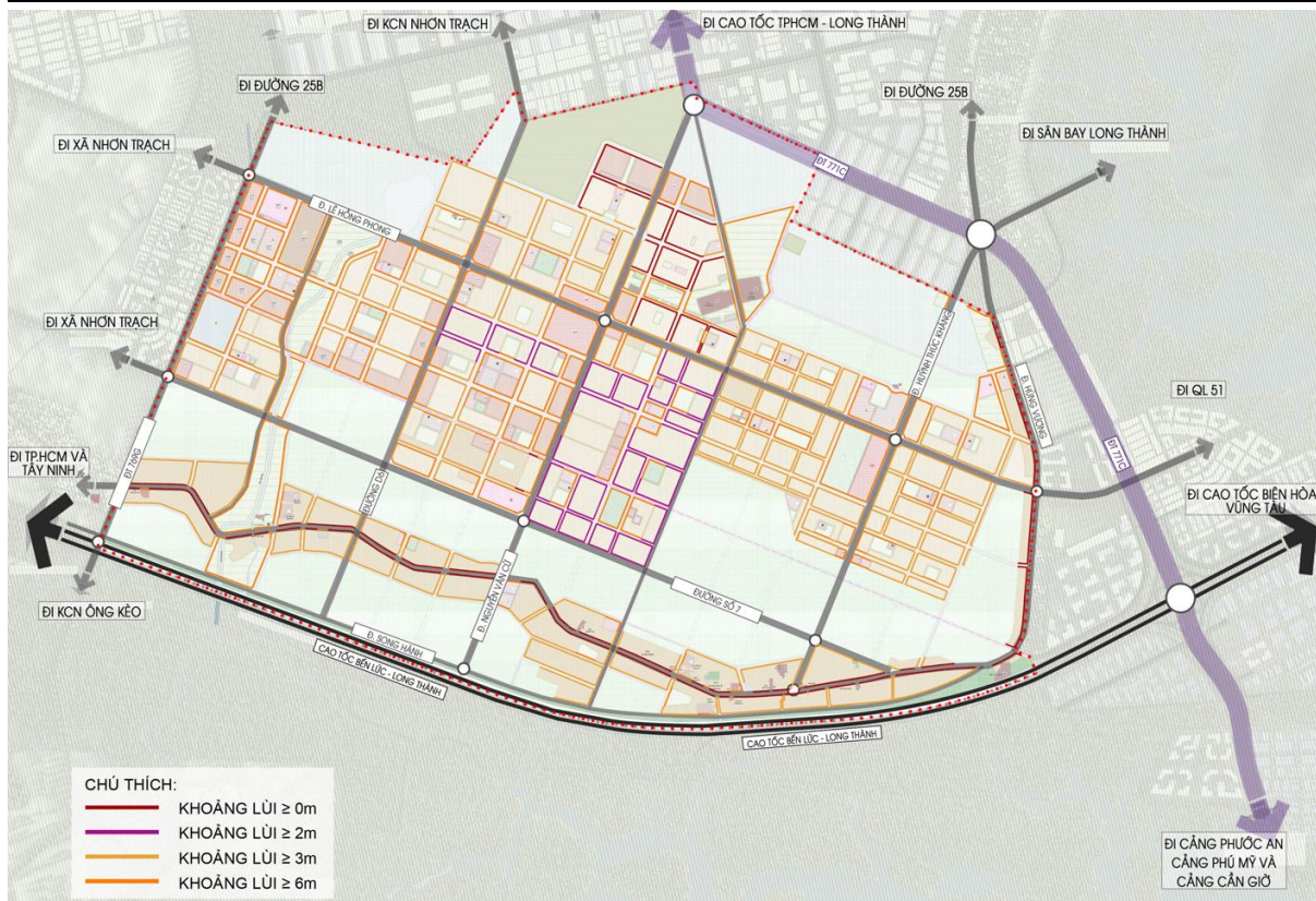
Hình 57. Quy định khoảng lùi trên các trục đường từ cấp phân khu vực
